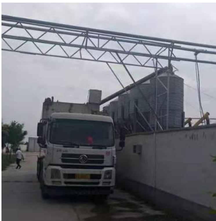
图2.3-6 饲料运输、上料（料车至料罐）
